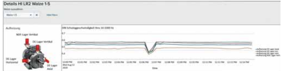
Abbildung 2: Darstellung einer Zeitreihenanalyse von Vibrationsmessungen an einem Walzenantrieb
